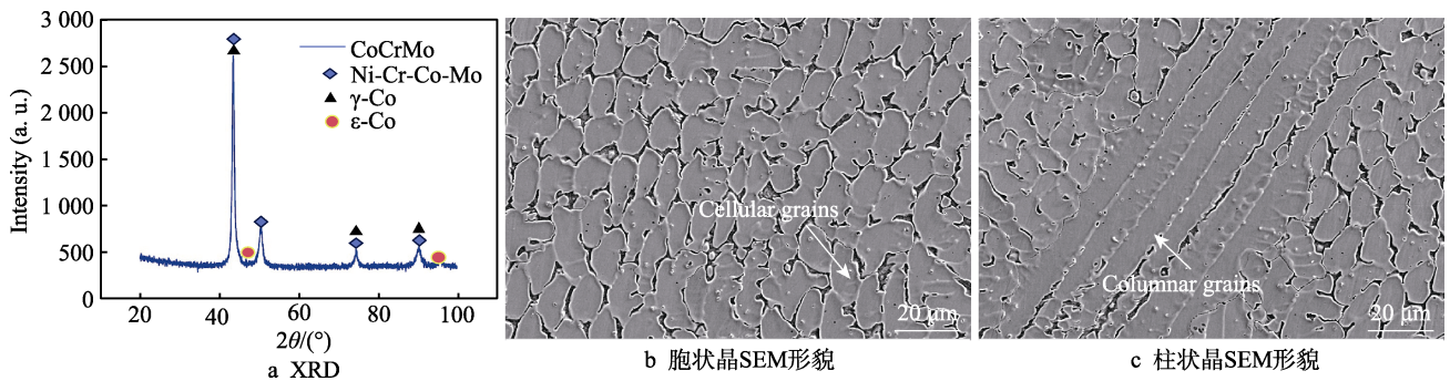
图 7 XRD 测试结果与 SEM 形貌
