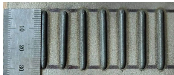
图 14 单道激光熔覆试验
