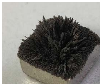
图 2 铁粉在永磁铁上的分布 Fig.2 Distribution of iron powder on permanent magnet
