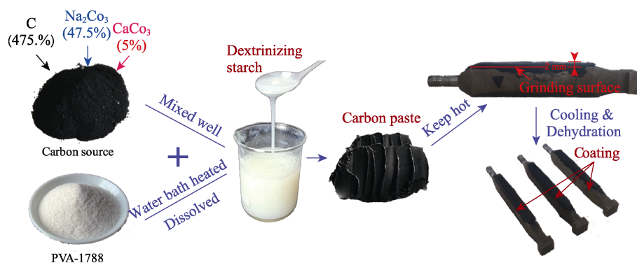
图 2 磨削表面预处理示意图
