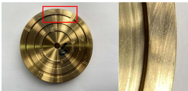
图 17 试验后滑靴表面 Fig. 17 Surface diagram of slipper after test
