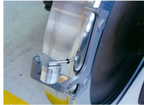
图 1 Miniprof 车轮型面测量
