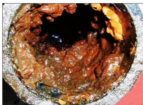
图 1 管线内壁结垢 [10]
