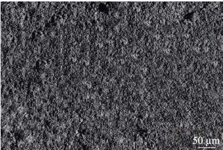
图 2 WC-12Co 涂层的表面形貌 Fig.2 Surface morphology of WC-12Co coating
