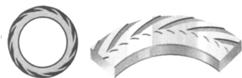
图 4 典型的单向螺旋槽非接触式机械密封的密封端面定域结构 [21]
