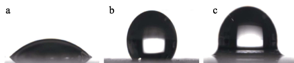
图 8 裸玻璃片 (a)、未灌注 (b) 和灌注 (c) PFPE 润滑液的硅烷聚合物网络涂层上的液滴状态 [59]
