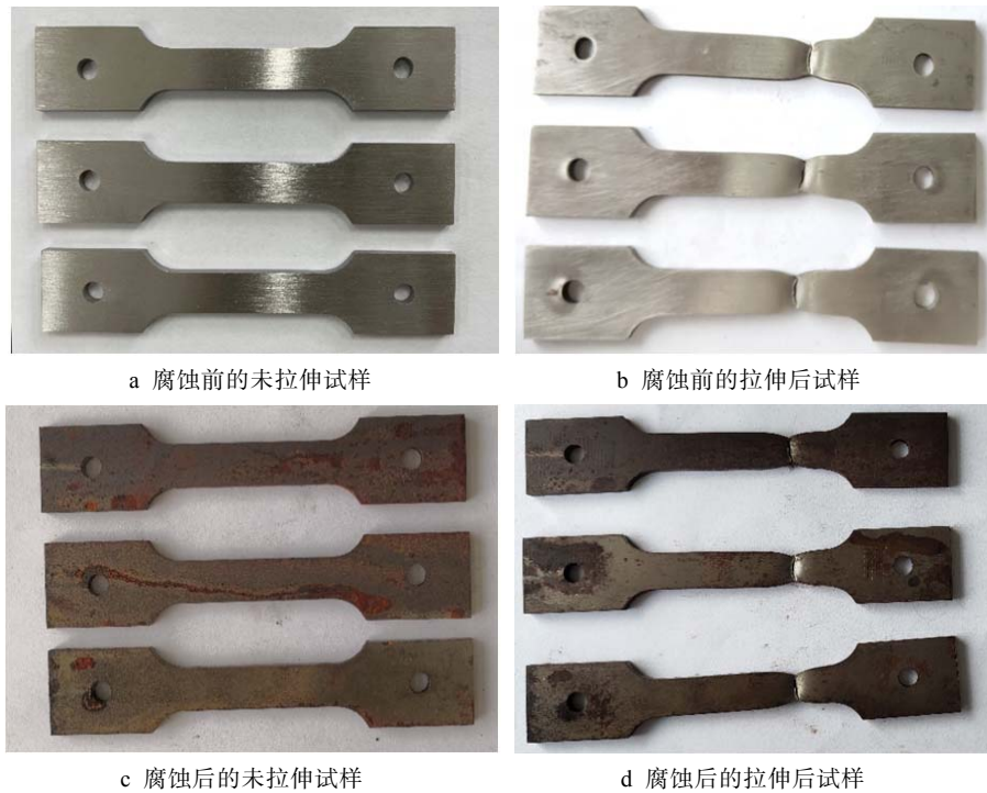
图 11 3Cr 钢腐蚀前后拉伸测试宏观形貌
