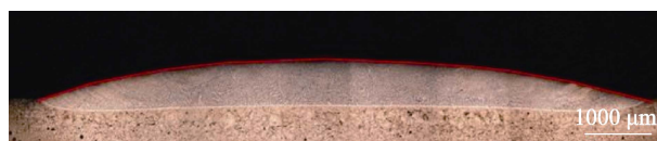
图8 矩形光斑熔覆层的横截面形貌 [27]
