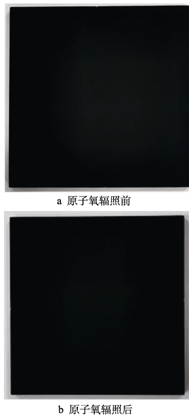
图 8 原子氧辐照前后 BN-1 镀层外观状态
