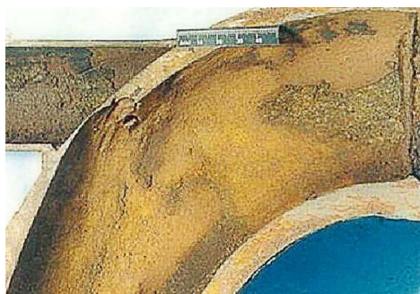
图 1 颗粒对弯管冲蚀的实物图 [1]
