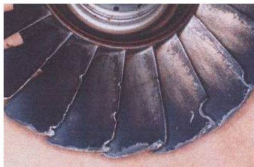
b 叶片的冲蚀损伤
