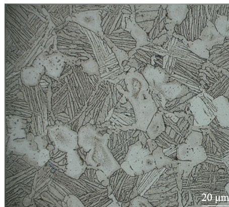
图 2 TC4 钛合金微观双态组织结构 Fig.2 Microstructure of TC4 titanium alloy
