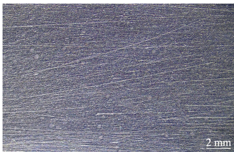
图 1 FGH97 试样超声喷丸前的表面状态
