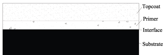
图 2 油漆结构界面示意图
