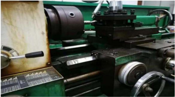
图 10 车削实验平台 CA6136 Fig.10 Turning experimental platform CA6136
