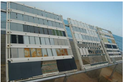
图 4 海洋平台暴露场样品投试情况 Fig.4 Photo of sample exposure on offshore platform
