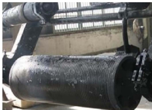
图 2 热浸镀 Zn 沉没辊表面结渣整体图 [9]
