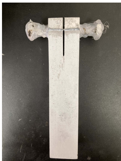
图 2 微弧氧化后的 DCB 试样 Fig.2 DCB sample after micro-arc oxidation
