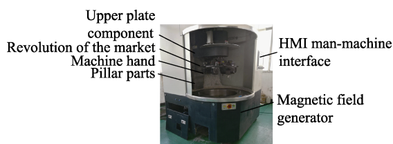
图 7 磁流变抛光平台
