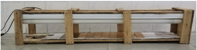
图 2 自制紫外老化箱 Fig.2 Self-made UV aging box
