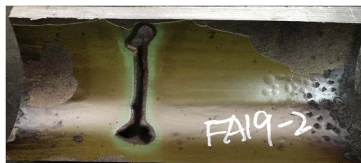
b 2#钻杆内壁涂层及刺孔形貌
