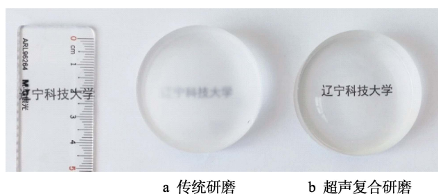
图 9 不同研磨工艺表面质量对比图
