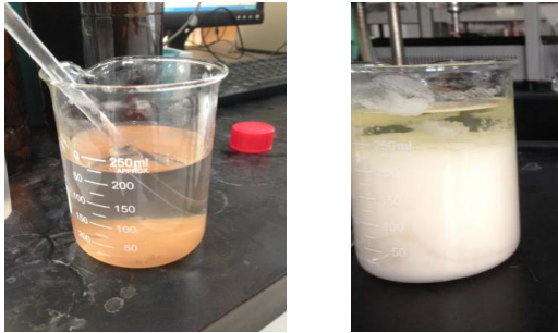
a 经氢氧化钾-乙醇溶液溶解后 b 经硝酸银滴定后
