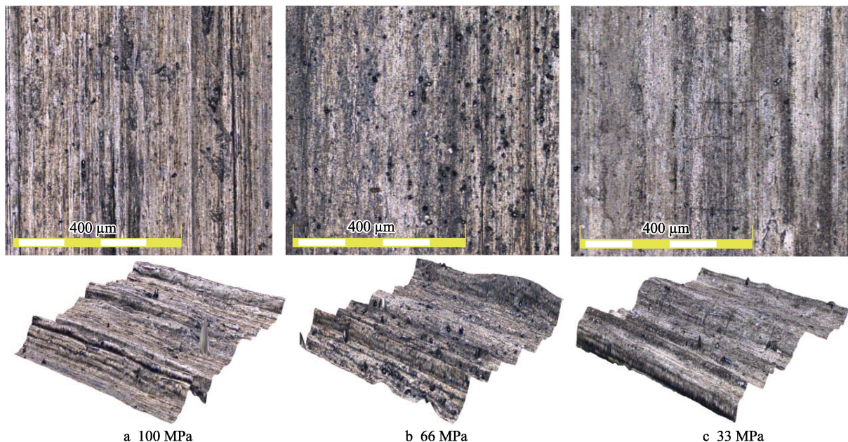
图 11 不同预应力下磨削工件表面微观形貌
