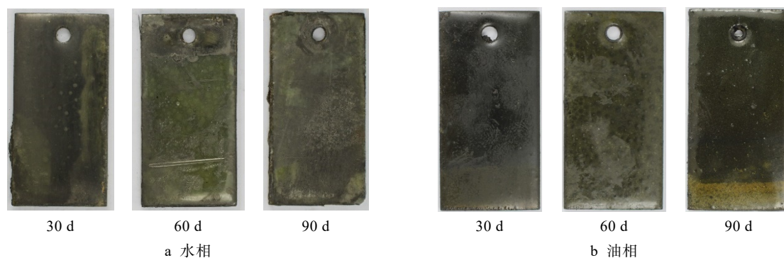
图 3 环氧纳米粉末涂层试样在不同环境中腐蚀后的宏观形貌
