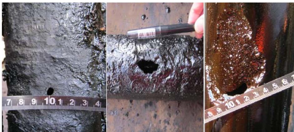
图 1 结垢腐蚀造成的管柱穿孔
