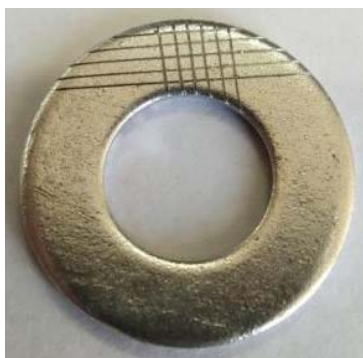
图9 镉镀层划格试验
