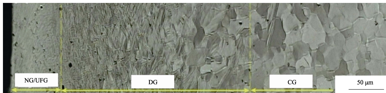
图 5 工业纯钛经 SNC 处理后组织沿深度的分布图 [10]
