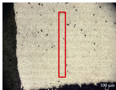
图 7 显微硬度测试位置
