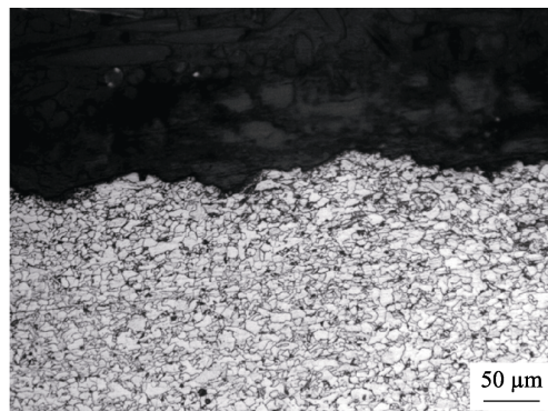
图 5 管体内表面腐蚀形貌及组织
