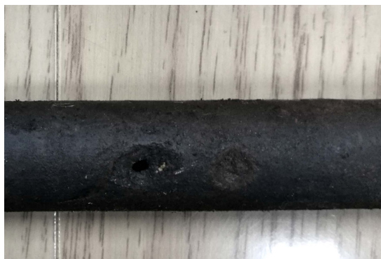
图 1 管束穿孔形貌
