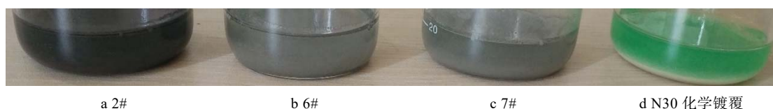
图 5 真空镀覆金刚石与化学 N30 镀覆的金刚石在酸液中浸泡 72 h
