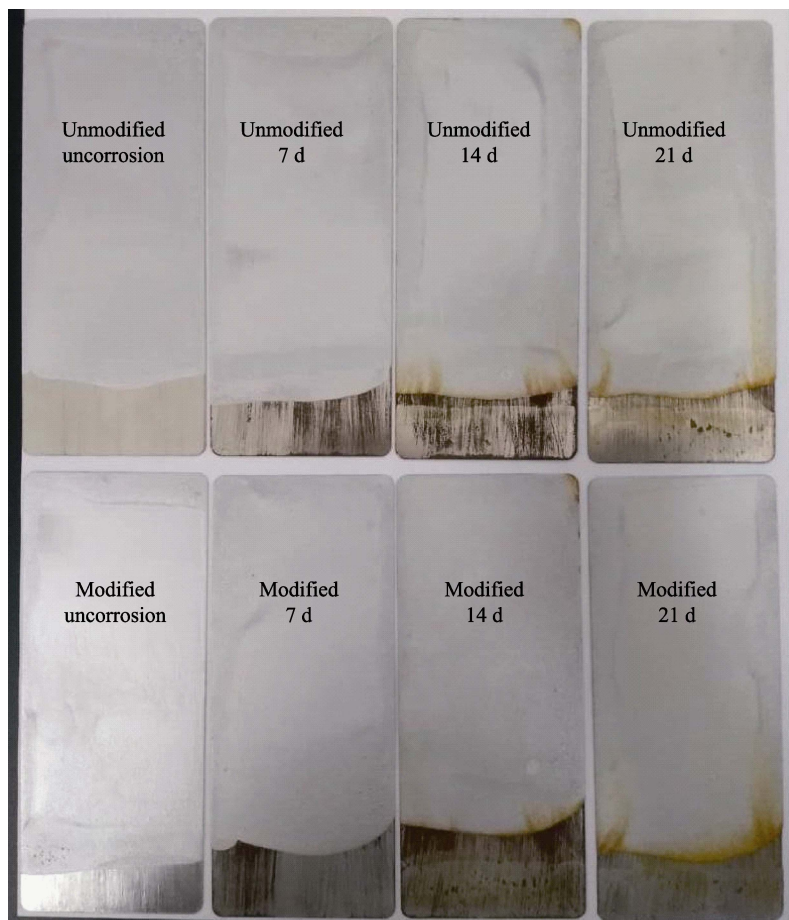
图 1 改性前后涂层经盐水腐蚀不同时间后的光学照片
