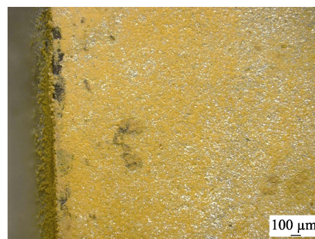
图 8 浸泡试件表面缺陷右侧边缘局部腐蚀
