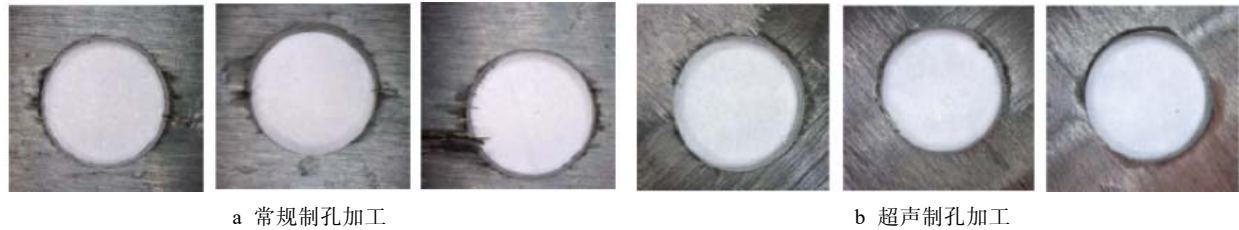
图 17 超声加工和常规加工制孔出口质量对比 [60]
