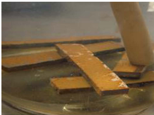
图 3 饱和 CO 2 溶液浸泡腐蚀后的试样
