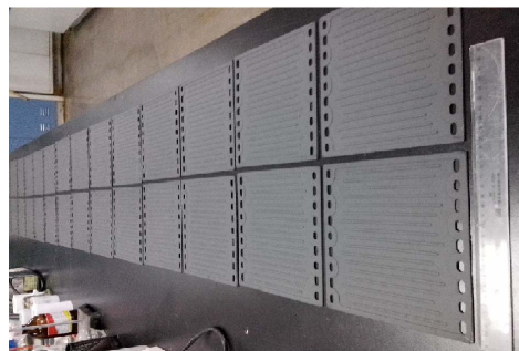
图 2 粉末还原法批量制备 SOFC 电堆用合金连接体涂层
