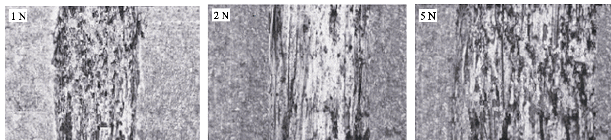
图 11 镀膜刀具在不同载荷下的磨痕形貌
