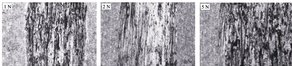
图 10 未镀膜刀具在不同载荷下的磨痕形貌
