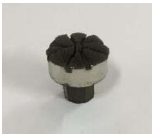
图 2 磁极装置 Fig.2 Magnetic pole device
