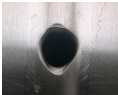
图 4 轴超声冲击后宏观形貌图
