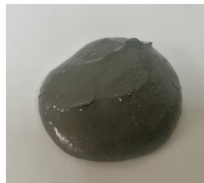
b 107硅橡胶为基体粘弹性磁性磨具
