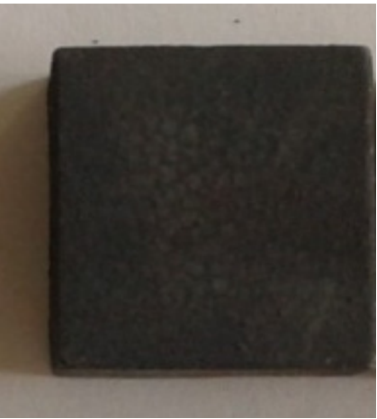
图 5 纳米涂层经过 50 次循环试验后的外观形貌 Fig.5 Nano-coating images after 50 thermal cycling test
