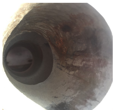
图9 采气树四通内壁冲蚀痕迹
