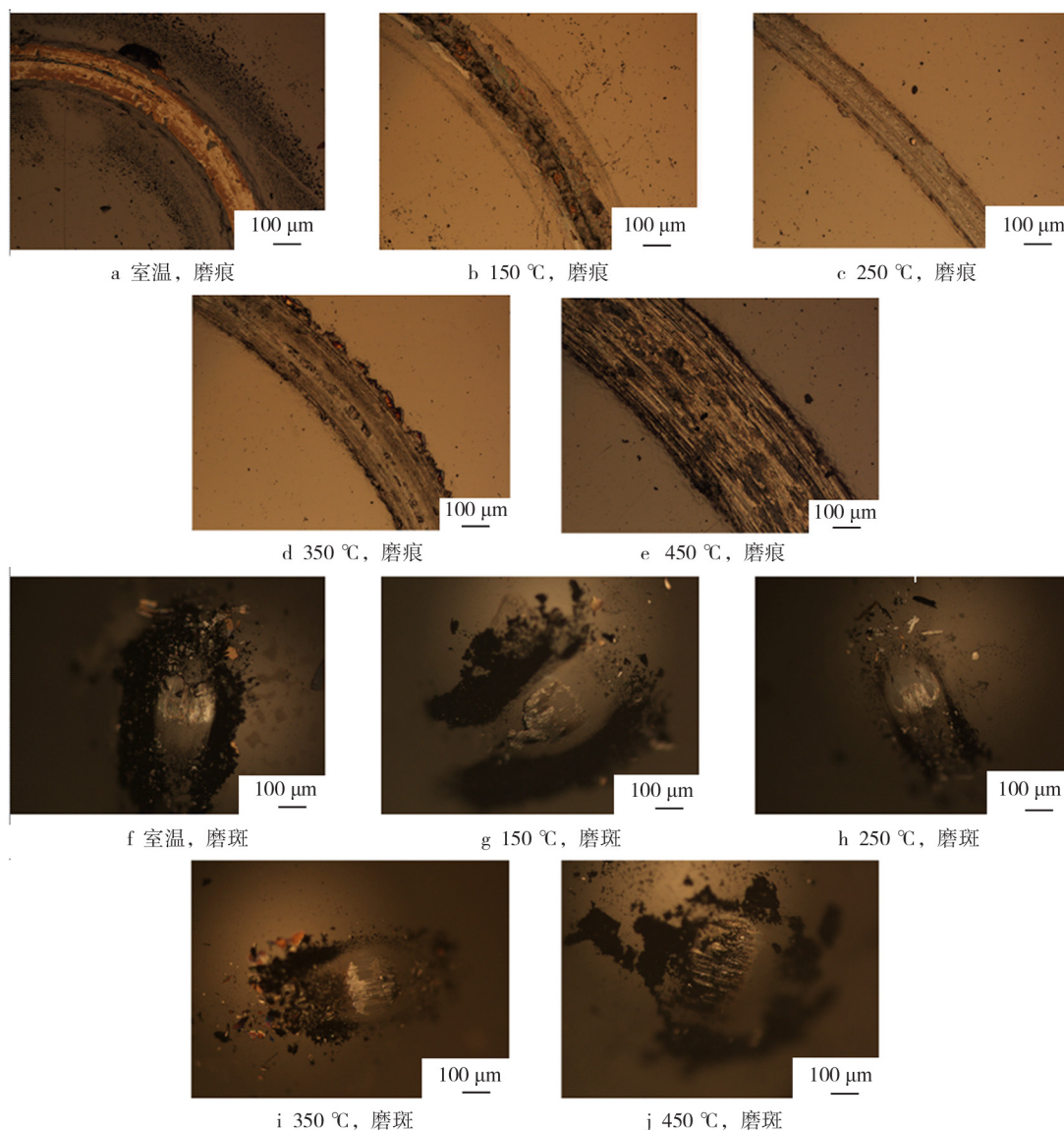
图 7 Al 含量为 18.3% 的 MoS 2 -Al 复合薄膜的摩擦试验磨痕及对应磨斑形貌
