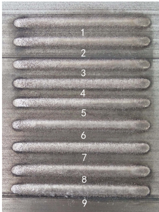
图 2 正交试验熔覆层的宏观形貌
