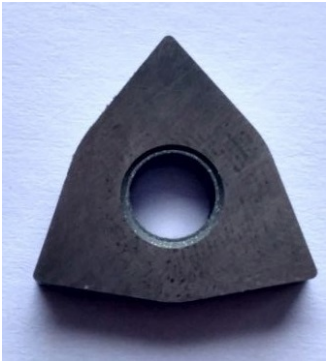
图 3 YG8 硬质合金刀片 Fig.3 YG8 carbide insert
