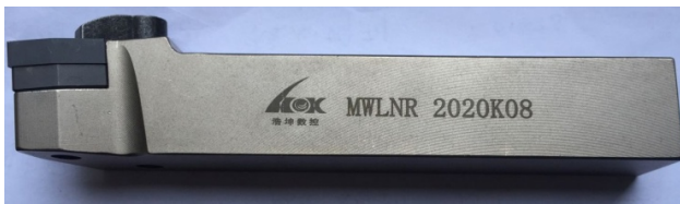
图 7 刀杆 Fig.7 Cutter bar
