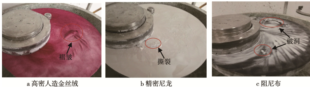
图 2 抛光垫破损示意图
